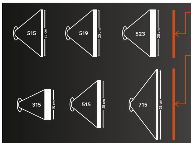
**Même largeur de jet - diamètre différent de l'orifice**
